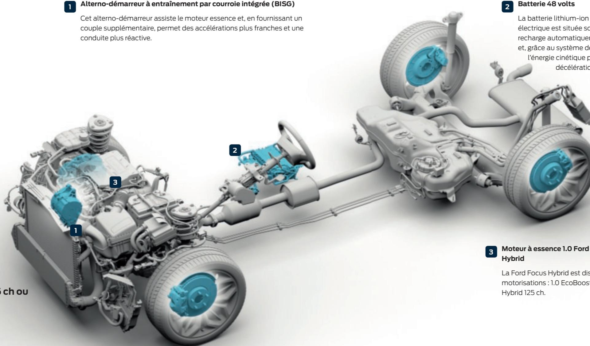
**1** **Alternateur à entraînement par courroie intégrée (BISG)**
